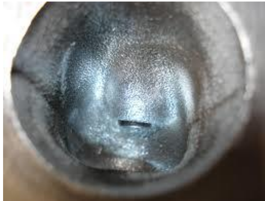
Figura 7 - Dutos do cabeçote sem polimento. Fonte: Clube do Monza
