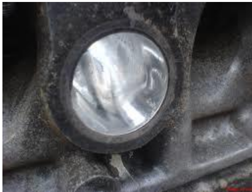
Figura 8 - Dutos do cabeçote com polimento. Fonte: Clube do Monza
