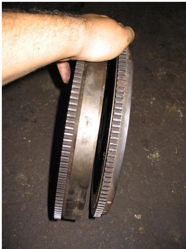
Figura 13 - Volante do motor com alívio de peso. Fonte: Clube do Kadett
